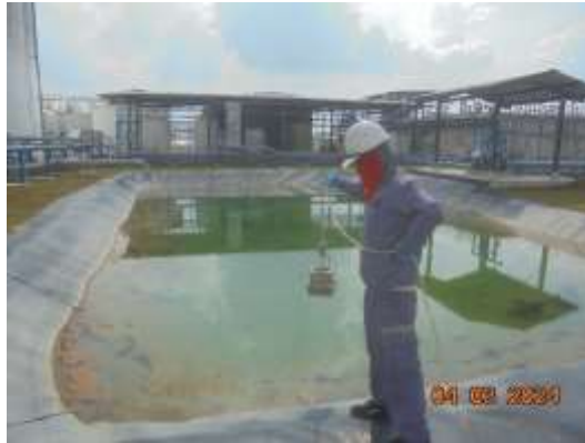
รูปที่ 3.4-13 การเก็บตัวอย่างตะกอนจากระบบผลิตน้ำประปา
